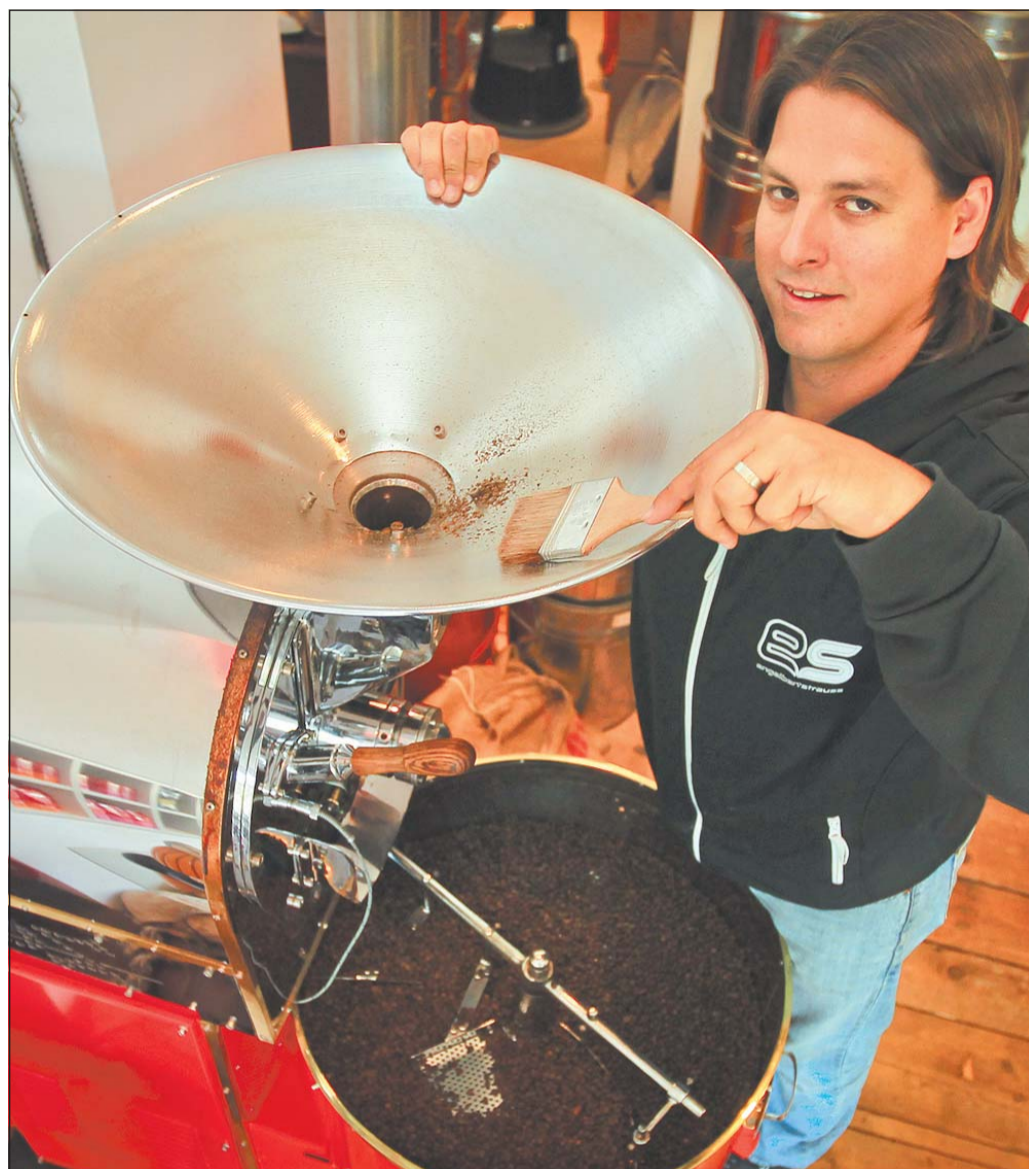
Oliver Erdmann am Trommelröster, in dem 12,5 Kilo roher Bohnen veredelt werden können. Er kauft teilweise direkt bei den Kaffeeplantagen. Fotos: Mike-Dennis Müller
